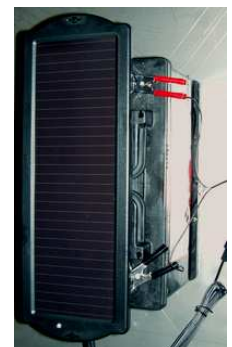
Solarzelle zur Nachladung und Erhaltung der 12V Batterie
