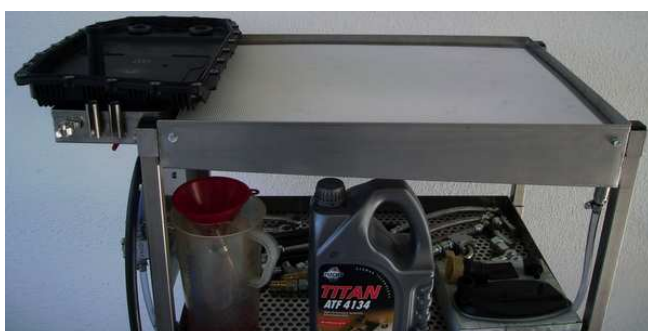
Montageauflage für die Ölwanne zum Wechseln der Ölwannendichtung.
