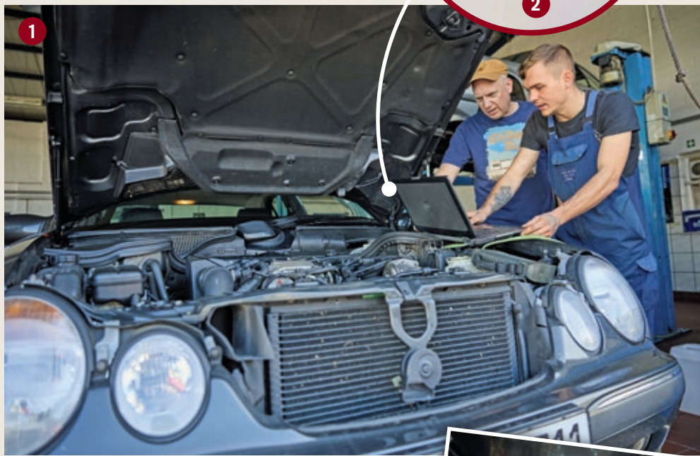
1 | Der erste Schritt ist das Auslesen des Fehlerspeichers
