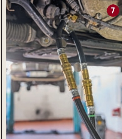
6 | Für jeden Fahrzeugtyp hat Tim Eckart einen passenden Adapter für die Anschlüsse am Automatikgetriebe
