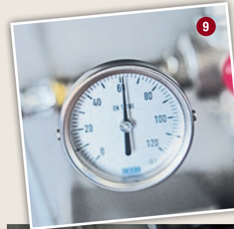
9 | Das Spülgerät misst diverse Indikatoren, auch die Temperatur. Beim Ablassen sollte das Öl 80 Grad Celsius heiß sein, damit sich alle Schmutzreste gut lösen
