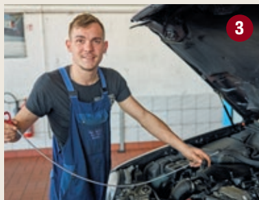
3 | Das Fünfstufengetriebe des Mercedes hat keinen eigenen Ölpeilstab mehr
