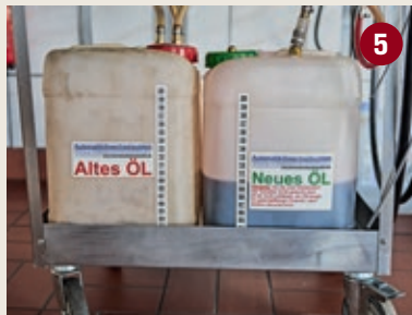
5 | Die korrekten Füllmengen für das Getriebe werden vorher exakt bemessen
