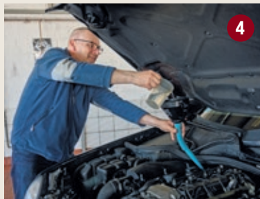
4 | Nach der Kontrolle des Ölstands füllt Tim Eckart 400 ml Reiniger ein
