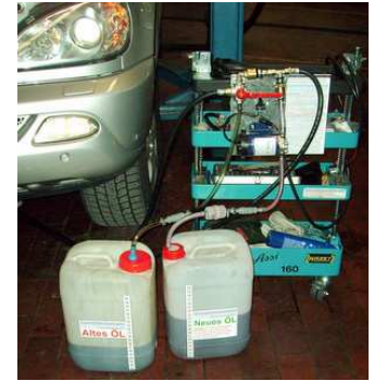
Ölwanne wird bei laufendem Motor + Gang D (S-Modus) (funktioniert nur , wenn Alle Antriebsräder blockiert sind ) kein Gas geben. Wenn viel Luft kommt 1,5 Liter Neues Öl Einpumpen. Dann noch einmal Leerpumpen lassen. Wenn viel Luft kommt in W/C-Modus schalten, dann Gang R + Motor aus.
