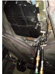
Porsche 928 S4 mit MB-Automatikgetriebe. Spülung wie beim 7-Gang da kein Peilstab sondern ein Überlaufbehälter neben der Ölwanne!
