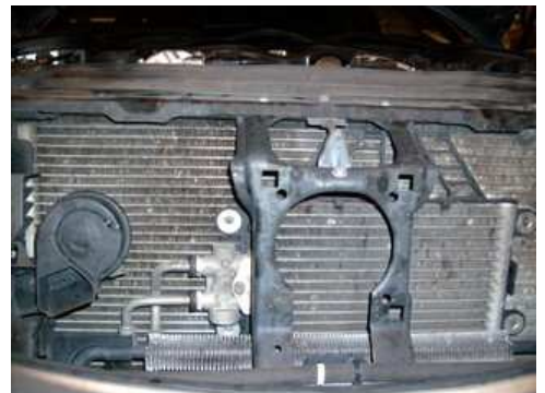
Zusatzölkühler für 280/ 320CDI V6 7Gang. Anschluß daran oben am Ausgang. Nur Spülen wenn sehr heiß und ohne Pause! Nicht auf der Hebebühne entlüften!!!
