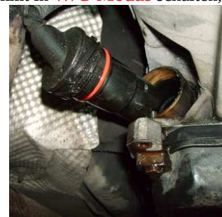
Ölwanne montieren ( 8 Nm ). EGS-Stecker abziehen und auf interne Undichtigkeit kontrollieren, bzw. gegebenenfalls erneuern ( 2,5Nm )!
