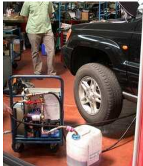
Chrysler 300C T 3.0 CRD + Grand Cherokee MB 5G. Angeschlossen an Vaneo + an A-Klasse W168, beide Ölwechselmenge ca. 7 Liter.
