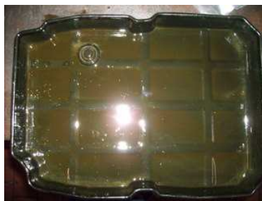
Normale runde Messingspäne in der Ölwanne. Magnet wird nachgerüstet.
