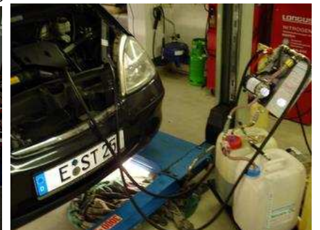
Chrysler 300C T 3.0 CRD + Grand Cherokee MB 5G. Angeschlossen an Vaneo + an A-Klasse W168, beide Ölwechselmenge ca. 7 Liter.
