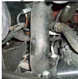
Adapter anschließen z.B. W251/W164 320CDI oben am Wärmetauscher (Rücklauf). Bei Schnellverschlußadapter am besten von oben!
