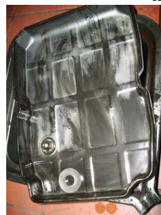
Ölwanne reinigen. Wenn erforderlich einen Magnet nach-rüsten! Ölfilter A1402770095 Dichtung A1402710080 EGS: A 203 540 02 53
