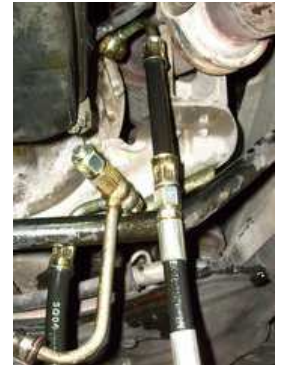
Adapter W163, ML 400CDI V8, Adapter AMG ML55. Dazu muß für den ML V6/8 eine andere Hohl-schraube(im Bild oben)verwendet werden.
