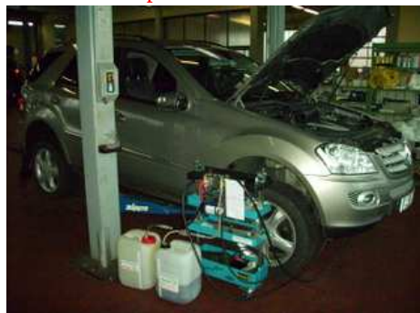
Adapter anschließen z.B. W251/W164 320CDI oben am Wärmetauscher (Rücklauf). Bei Schnellverschlußadapter am besten von oben!
