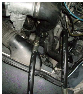
Winkeladapter an W168, 170CDI und Vaneo. Ölwechsel mit 7,5Liter.
