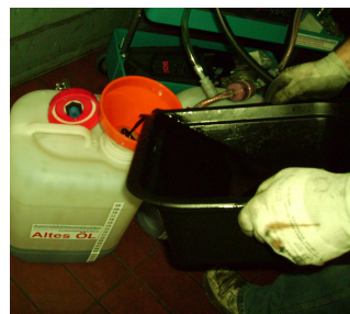
Nun sind ca. 8/(7) Liter Altöl im Kanister. Neues Öl ca. bei 8/(7) Liter Marke. (Evtl. danach: Hat der Wandler eine Abblaß-Schraube, kann das Öl zusätzlich in den Kanister Altes Öl abgelassen werden).
