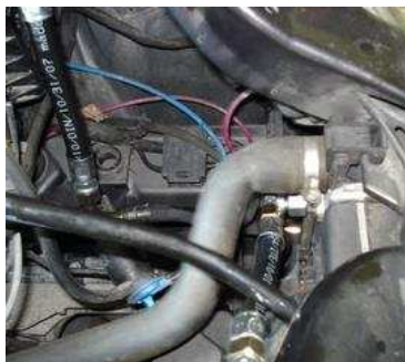
Winkeladapter an W168, 170CDI und Vaneo. Ölwechsel mit 7,5Liter.
