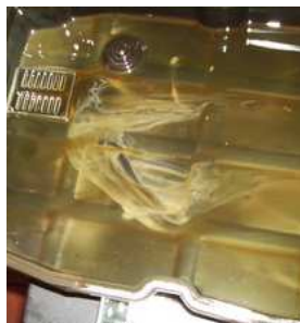
Abbau der Ölwanne. Dafür muß die Ölablaßschraube nicht entfernt werden. Altöl des Ölfilters+Ölwanne auffangen. Ölfilter+Dichtung wechseln. 0,3-0,5 Liter Rest Altöl aus der Ölwanne + Ölfilter in den Kanister ( Ablaßhahn der Service-station kurz öffnen )
