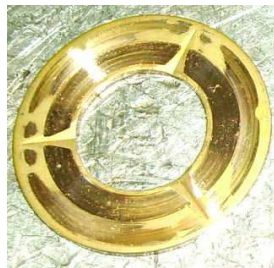
Grund für den Abrieb sind die Zahnradabstandsscheiben aus Messing.
