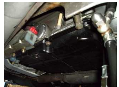
Porsche 928 S4 mit MB-Automatikgetriebe. Spülung wie beim 7-Gang da kein Peilstab sondern ein Überlaufbehälter neben der Ölwanne!
