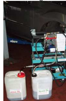
Adapter anschließen z.B. beim W221 unten am Wärmetauscher. Immer die rechte Rücklaufleitung!
