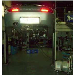
Porsche 928 S4 mit MB-Automatikgetriebe. Spülung wie beim 7-Gang da kein Peilstab sondern ein Überlaufbehälter neben der Ölwanne!
