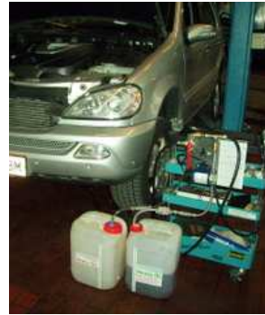
Start mit 10/(9) Liter Neues Öl z.B. am W163 ML400CDI in der Wechselstellung (Hebel waagrecht).
