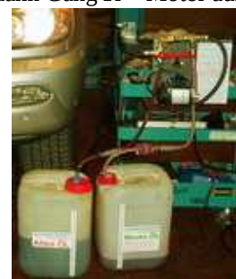
Ölwanne wird bei stehendem Motor mit 5 Liter Neues Öl befüllt (bis zur 3,5/(2,5) Liter Marke) durch einschalten der 12V Ölpumpe.
