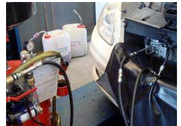
Anschluß oben am Zusatzölkühler.
