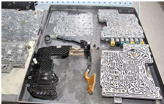
**Eingemachtes:** Der „Premium-Getriebeölwechsel“ von ZF Services beinhaltet umfangreiche Prüf- und Reinigungsarbeiten – Beispiel Schieberkasten.
