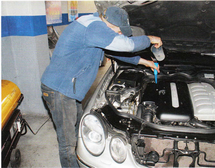
Zugabe: Vor einer Ölspülung füllt Tim Eckart einen speziellen Reiniger in das Automatikgetriebe ein und betreibt dieses eine bestimmte Zeit in sämtlichen Gangstufen. Damit sollen sich vorhandene Ablagerungen im Hydrauliksystem lösen. Bild: Schmidt
