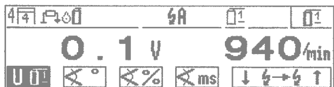
Mehrkreis-Zündanlagen (zwei Zündverteiler, Einzel-Funken- und Doppel-Funken-Spulen) mit Angabe der Zündkreisbezeichnung bei DFS im Beispiel ist Kreis A angewählt
