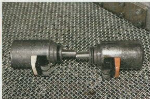
Ein Magnetventil (rechts) zeigt abnormale Werte und wird durch ein neues (links) ersetzt. Die anderen werden gereinigt und weiter verwendet
