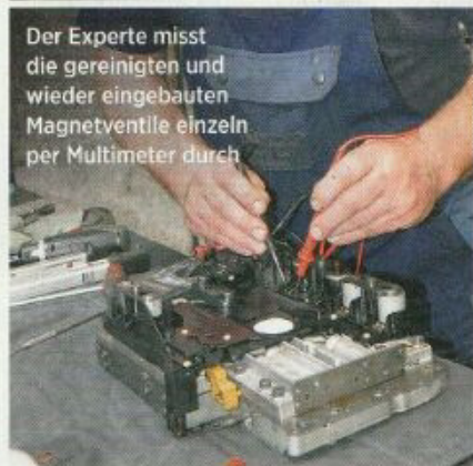
Die Schalt-Magnetventile werden ausgebaut und gereinigt. Verdeckte Kontakte sind potentielle Fehlerquellen
