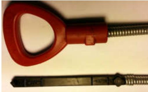
MB 9 Gang Werkzeug zum Überprüfen des Ölstandes, Nachfüllen des Öles mit AG32. 15€ zzgl. MwSt
