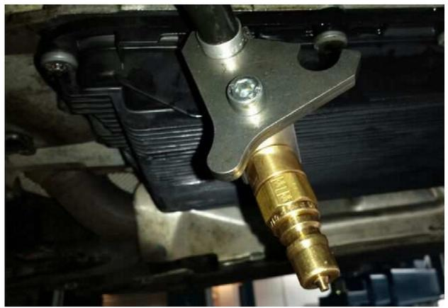
AG30: Steckverbindung am Plattenwärmetauscher BMW 5, 6, 8 Gang, Range Rover ZF 6-Gang. + Öffner. Einzelpreis 108€ zzgl. MwSt.
