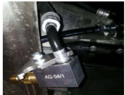
6HP21: hier wird gemixt mit AG 02/2 und AG 04/1 mit extra Gummi O-Ring 12/18mm verspannt.
