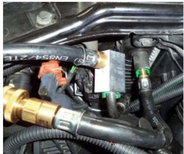
AG13: (AG02 wird benötigt) Adaption unten am Getriebe bei Aisin-Warner 6-Gang Getrieben mit Blockwärmetauscher wie z.B. Volvo V70 oder Ford Mondeo. Adaption (AG30 wird benötigt) am Wärmetauscher für Volvo 6 Gang, Ford Mondeo und weitere Ford Modelle mit Plastikkupplung. 39€ zzgl. MwSt.
