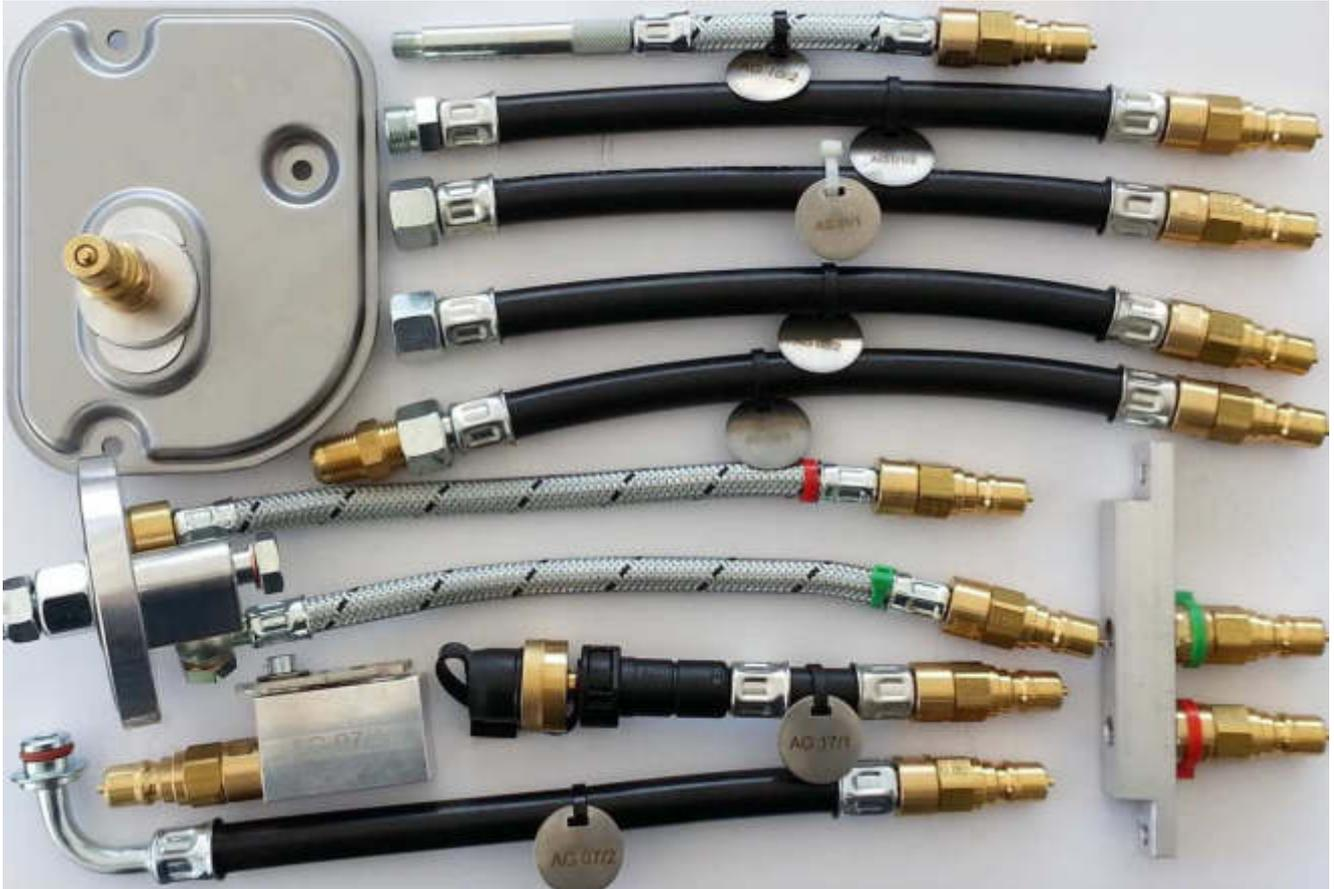
AG01: Audi ZF 5-Gang (5HP19, 5HP24), ZF 6-Gang (6HP19, 6HP26, 6HP32) in A6 + A4 teilweise; VW Phaeton; Bentley Continental ZF 5 und 6-Gang; Audi mit Multitronic Getriebe; VW Passat TDI 4 und 5-Gang; MB Vito mit ZF Frontantriebs-Getriebe; VW T5 mit Aisin-Warner-Getriebe; Volvo ab Bj. 2001 (S/ V40, V50, S60-C/ S/ V70, S80, XC70, XC90, Crosscountry), Aisin-Warner AW55-50SN 5-Gang. SW 19/ 22mm, M18x15. Einzelpreis 89€ zzgl. MwSt.
