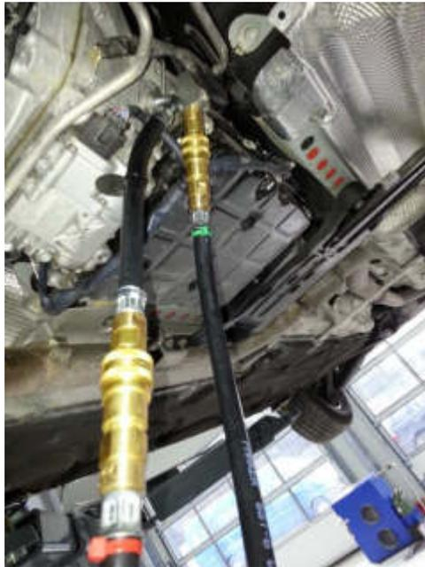
AG24: (bestehend aus AG 24/1 und AG 24/2) MB 7-Gang Steckanschluß 14mm unten vorne am Kühler von W211/SLK/ CLK -Benziner. Einzelpreis 89€ zzgl. MwSt.
