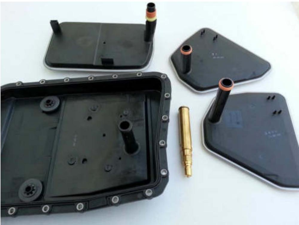
Kunden Idee 8HP. Ablaufloch und Loch für AG33+AG11 gebohrt zum Spülen über Ölfilteranschluß.
