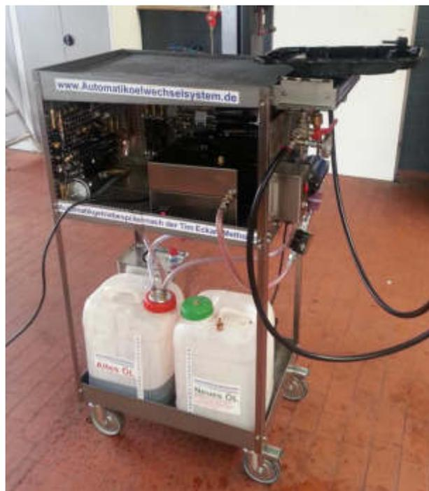
Pulsierende Kühlerreinigung, in Verbindung zum Heizgerät; aufschraubbarer Feinstfilter, (ermöglicht eine pulsierende Reinigung/Spülung mit wechselnder Flussrichtung des Kühlers in Kombination mit eingespeister pulsierender Druckluft). AGSG\_Z2 1.849€ zzgl. MwSt.
