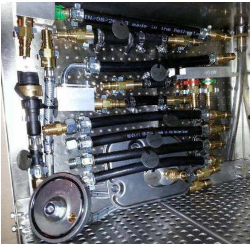
Adaption zum Spülgerät, (ermöglicht Anbringung der MB-, BMW-, Audi/VW-Adaptersets, bestehend aus 3xEdelstahl-Lochblech-Wänden links + rechts + hinten, intelligente Anordnung der Adapter, Restöl fließt sauber ab). 439€ zzgl. Mwst.
