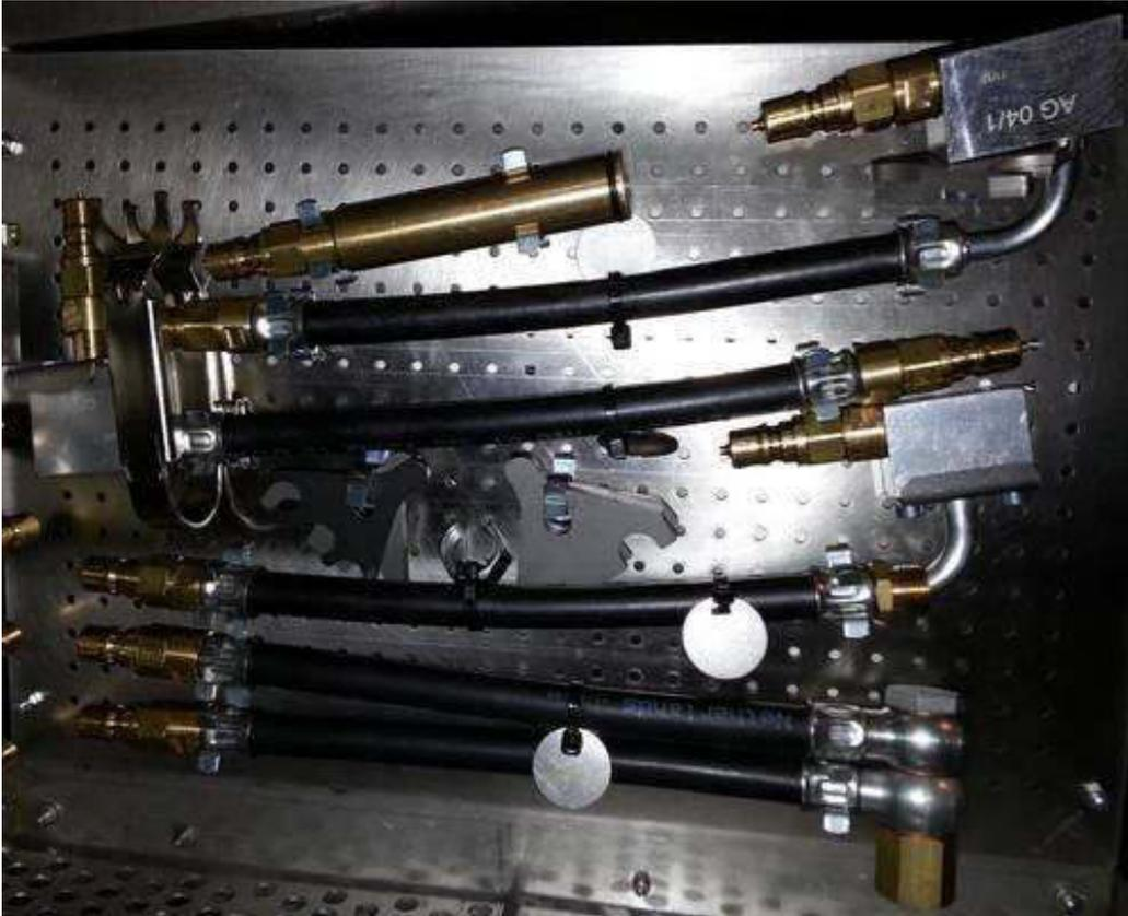
Adaption zum Spülgerät, (ermöglicht Anbringung des Audi/VW-Adaptersets, bestehend aus 1xEdelstahl-Lochblech-Wand links, intelligente Anordnung der Adapter, Restöl fließt sauber ab). 149€ zzgl. Mwst.
