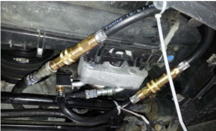
AG05: Volvocars 6 Gang/ 5 Gang Aisin-Warner Getriebe mit 12mm Steckleitungsanschluß und grünem Halteclip im Kühler. 108€ zzgl. MwSt.
