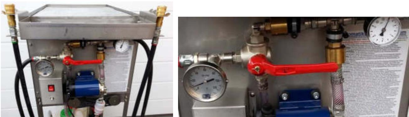
Sperrhahn zur Reduzierung der zugeführten Neuölmenge bei der Spülung mit abgebauter Ölwanne. 10€ zzgl. Mwst.
