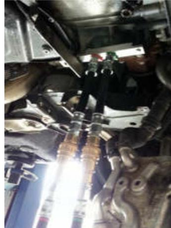
AG10: Zur Adaption über den Ölfilter beim Aisin Warner 6 Gang Getriebe, Ölfilter 09M 325 429, Befülleinrichtung, A3, TT, New Beetle, Golf 5, Polo, Touran, Passat, Tiguan, T5, Seat: Altea, Toledo, Leon, Octavia und Mini mit 6 Gang. Befüllen Porsche mit MB 5 Gang +VW/Porsche mit Aisin-Warner 8 Gang usw... Einzelpreis 128€ zzgl. MwSt.
