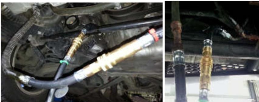
AG28: Winkeladapter MB 5-Gang M16x1,5 Schraubanschluß am Kühler oder da wo wenig Platz ist mit Schlüsselweite 19mm. Einzelpreis 68€ zzgl. Mwst.
