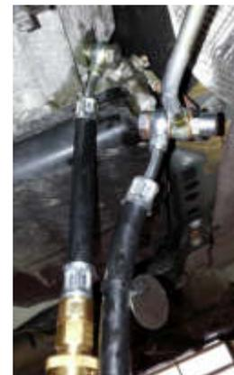
AG29: Adapter zum Anschluß direkt am MB 7G Getriebe links oder rechts. Blockadapter nun mit 2 Befestigungslöchern zur einfacheren Montage. Einzelpreis 108€ zzgl. MwSt.
