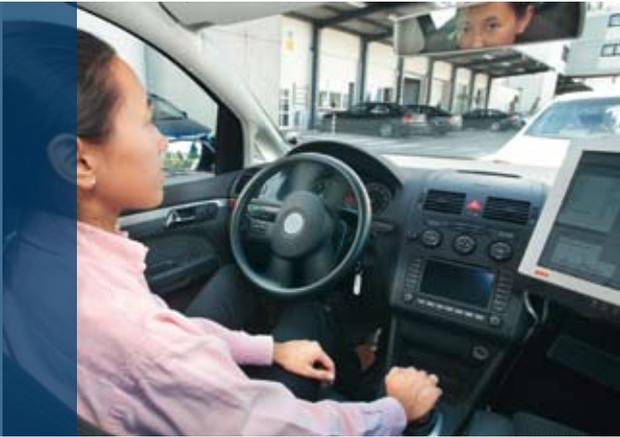
Noch vor einigen Jahren Vision ist der Einparkassistent seit 2008 Realität. Die Vermessung der Parklücke erfolgt automatisch und wie von Geisterhand führt die Elektronik alle Lenkbewegungen ohne Zutun des Fahrers aus.
