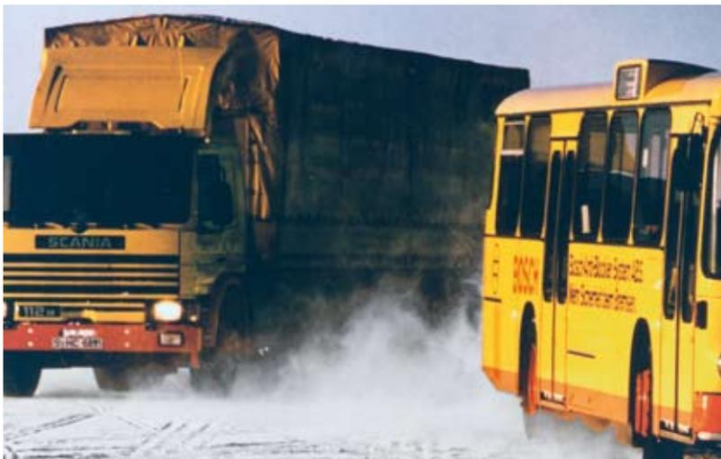
Im nordschwedischen Arjeplog testet Bosch seit den 1970er Jahren Systeme für Bremsen und Fahrwerk. Im Lastwagen und im Bus werden das ABS und die damals kurz vor der Serienfertigung stehende Antriebsschlupfregelung ASR auf Herz und Nieren geprüft (1986).
