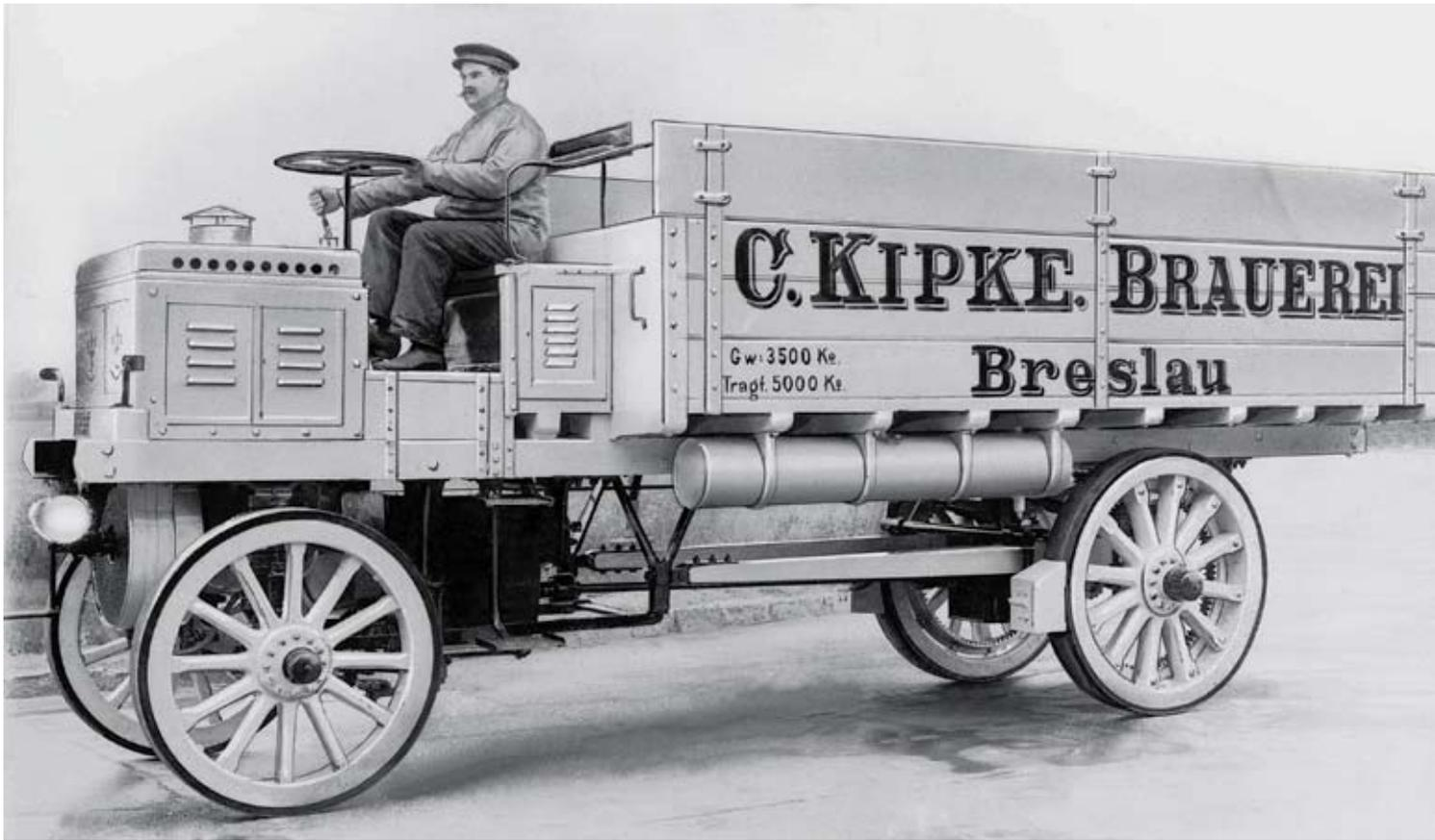
Der Lastwagen Typ Daimler Phönix war das erste Kraftfahrzeug, das serienmäßig mit Bosch-Magnetzündung ausgerüstet war.
