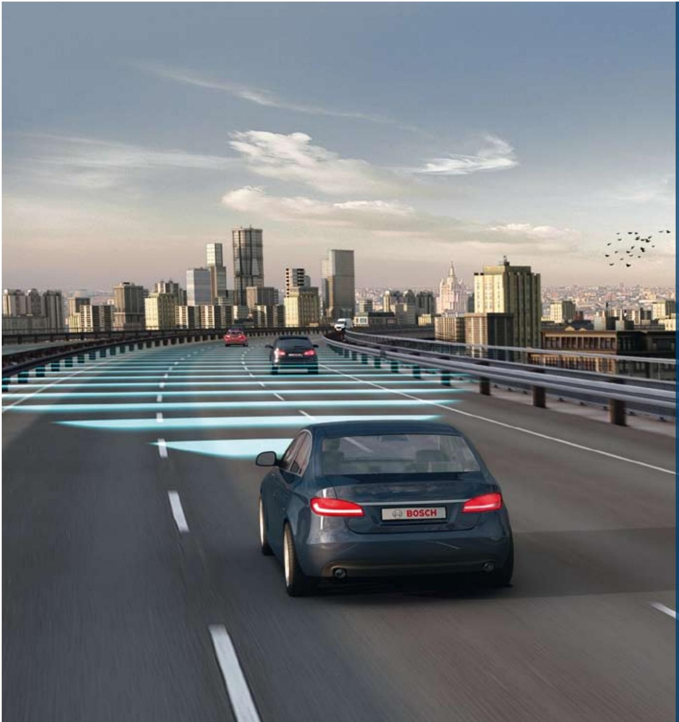
Das im Jahr 2000 eingeführte Abstandsradar ACC (Adaptive Cruise Control) gehört zu den ersten komplexen elektronischen Fahrerassistenzsystemen. Es sorgt für gleichmäßigen Sicherheitsabstand, auch wenn das vorausfahrende Fahrzeug gebremst wird.
