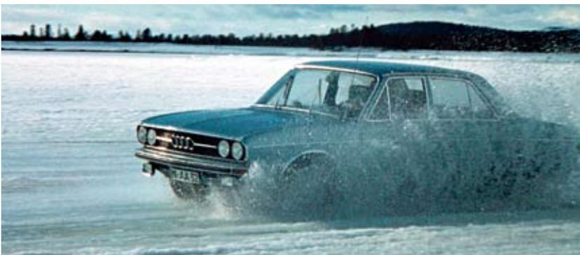
Im nordschwedischen Arjeplog testet Bosch Fahrwerksysteme auf zugefrorenen Seen. Im Bild ein Audi 100 GL mit Vorserien-ABS an Bord (1975)
