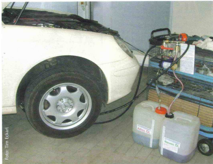
Das Ölwechselsystem von Tim Eckart verlängert die Lebensdauer von Automatikgetrieben erheblich und erspart so in vielen Fällen ein teures Austauschgetriebe.
